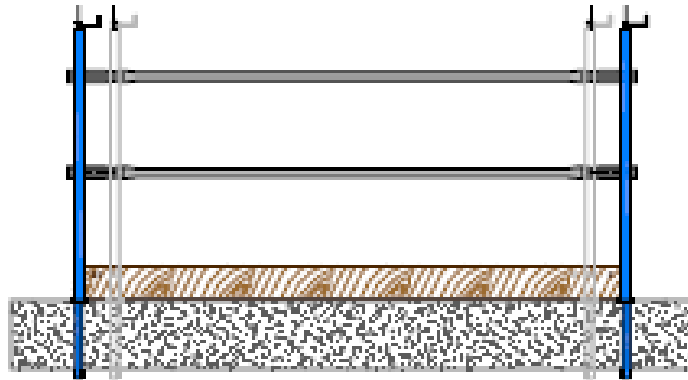
Abbildung 2: Montage der Komponenten des Seitenschutzsystems
